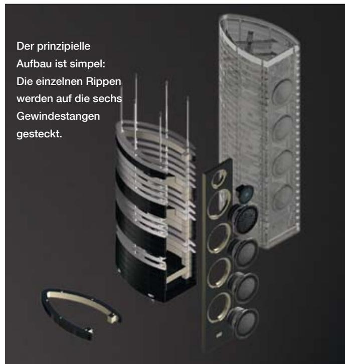
Der prinzipielle Aufbau ist simpel: Die einzelnen Rippen werden auf die sechs Gewindestangen gesteckt.
