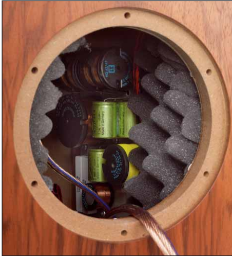
Die aufwändige Weiche ist mehrteilig aufgebaut, ein Teil davon sitzt an der Wand des Bassgehäuses
