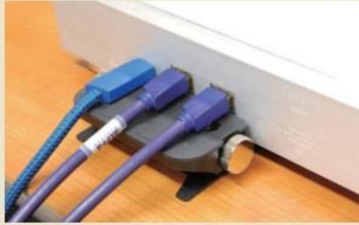
fidataのミュージックサーバーHFA S1-H40の、USBとLAN端子にNCF Booster-Signal-Lを挿入。端子がぐらつきやすく、低い部位には特に効果を発揮する
