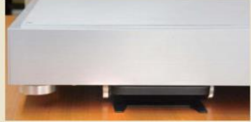
機器のシャーシの下にNCF Booster-Signal-Lを3個入れて3点支持。ダイレクトインシュレーターとしての効果も確認できた(写真はfidataのミュージックサーバー)
